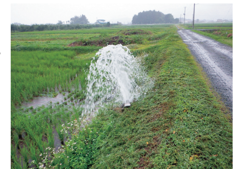
上段：大沢地区の不法投棄物 下段：草刈り作業による給水栓破損
